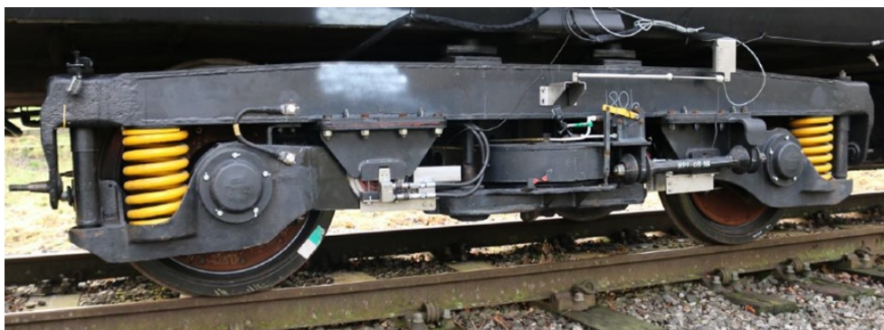
Obr. 2 Zástavba systému LiCAS do železničního podvozku [3]
