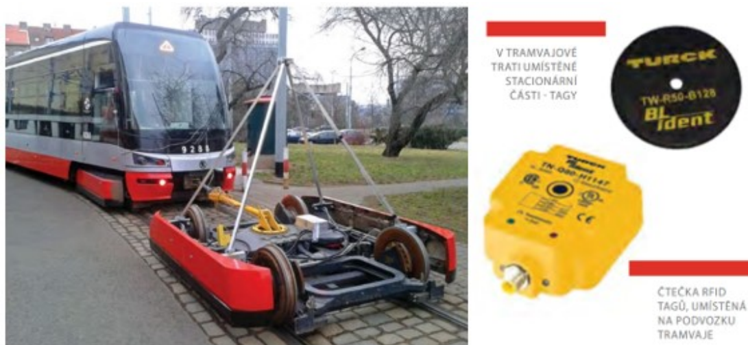
Obr. 4 Měřící zařízení průjezdu trati (vlevo). Sledovací RFID tag a čtečka (vpravo) [5]
