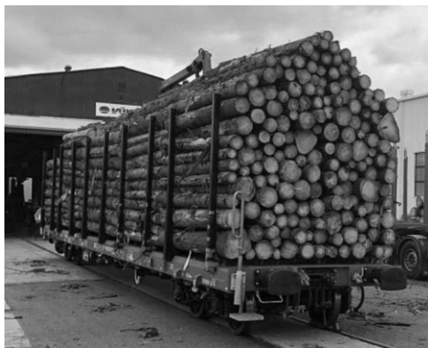
Obr. 10 Naloženie vozňa „do koruny“ počas skúšok vo VÚKV
