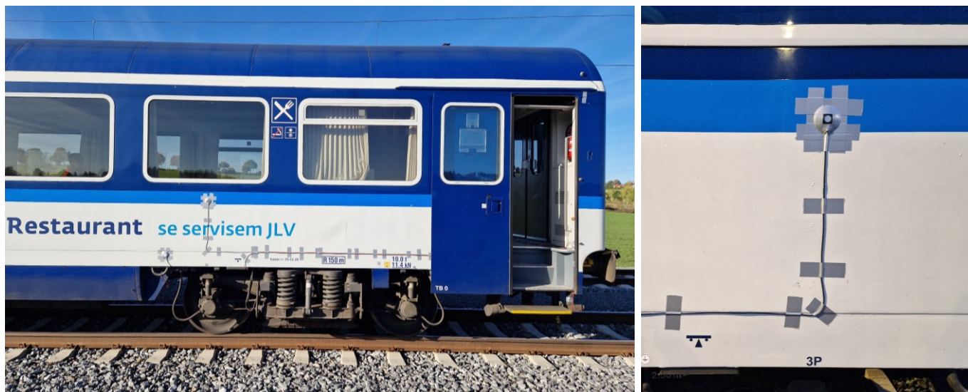
Obr. 5 Ukázka instrumentace při zkoušce na vozidle – celkový pohled na umístění tlakového snímače na bočníci vozu WRmz 817 (vlevo) a detail snímače (vpravo)
