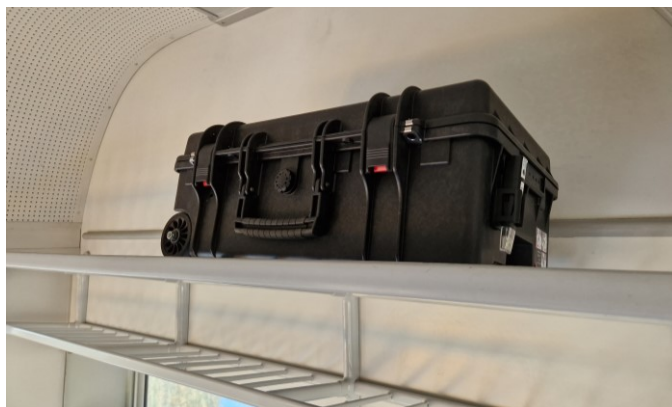
Obr. 8 Ukázka instrumentace pro záznam tlakových změn ve vozidle při zkoušce tlakového komfortu
