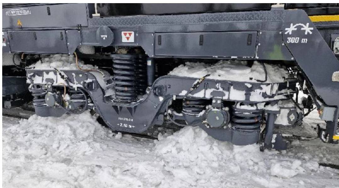
Obr. 16 Simulace ztížených arktických podmínek na lokomotivě
