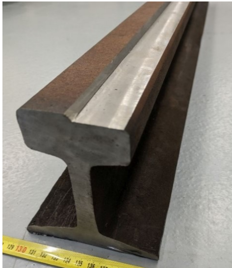
Obr. 4 Vytvořená drážka pro navařování plazmou
