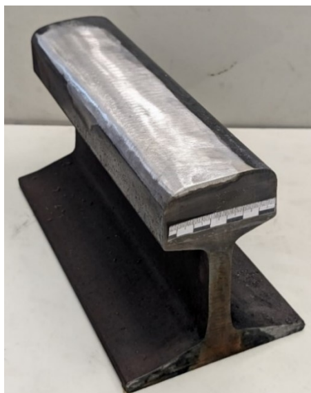
Obr. 1 Vytvořená povrchová vrstva v kontaktní ploše kolejnice
