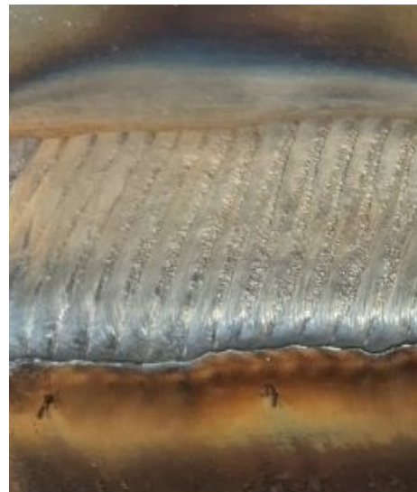
Obr. 5 Detail kontaktní vrstvy navařené plazmou
