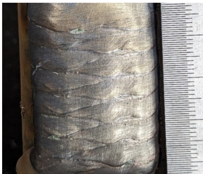
Obr. 1 Vytvořená povrchová vrstva v kontaktní ploše kolejnice
