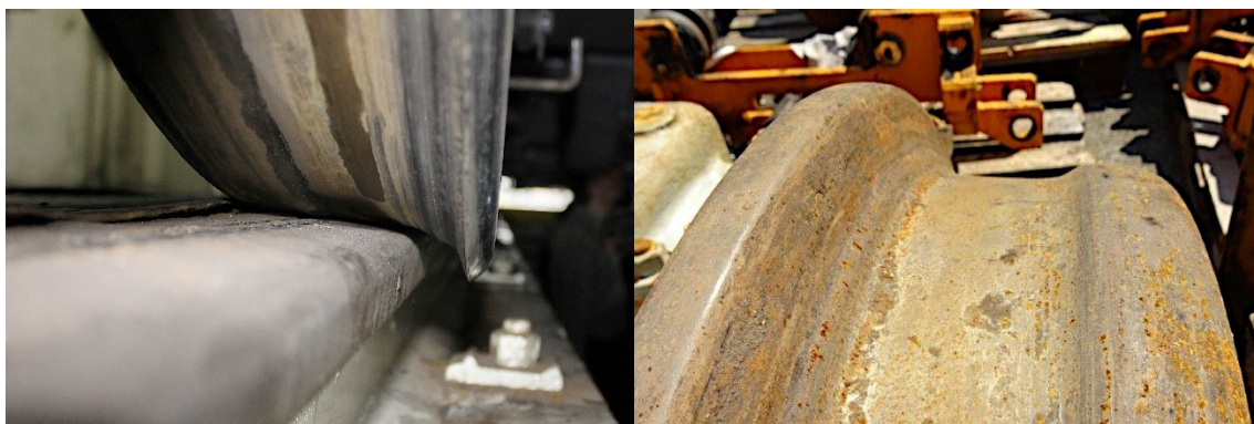
Obr. 1 Nadměrné opotřebením okolku (vlevo); nadměrné opotřebením středu jízdní plochy (vpravo)
