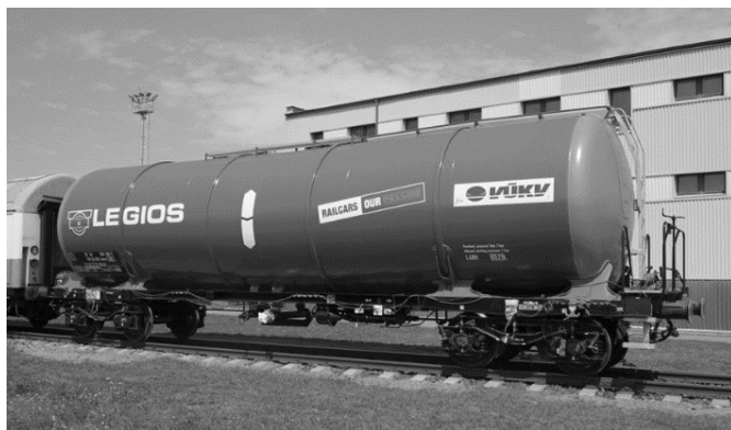
Obr. 1 Cisternový vůz řady Zacns 88 m 3
