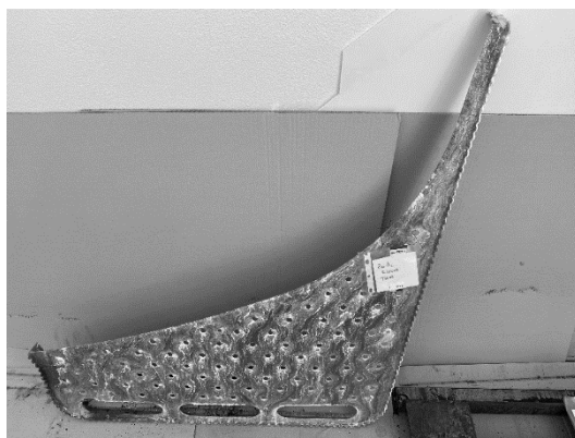
Obr. 6 Čelní pochozí rošt lokomotivy po zkoušce v klimatické komoře po 1 000 hodinách
