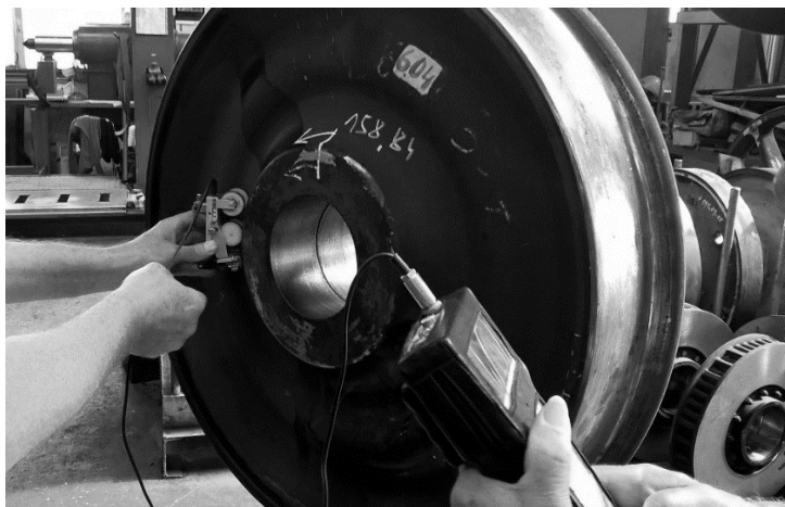
Obr. 5 Měření intenzity magnetického pole náboje kola před nalisováním (a po nalisování) [1]
