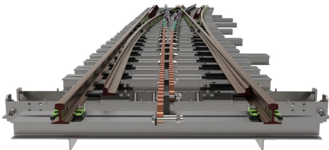
Obr. 4 Pohled na ozubnicovou výhybku od výměnové části – zřejmý je žlabový pražec, ocelové pražce a rozbíhající se lamely dvoulamelového Abtova systému ozubnice
