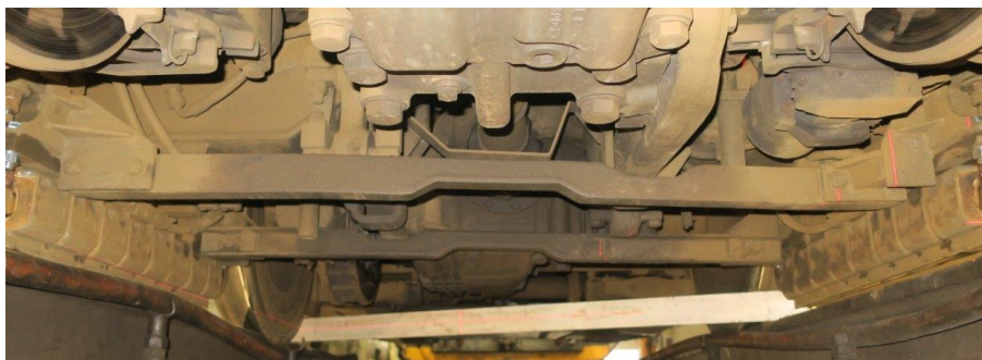
Obr. 12 Rozpěry kolejnicové brzdy s vybráním pro ozubnicový hřeben; zdroj: Ing. Hartman (Správa železnic)
