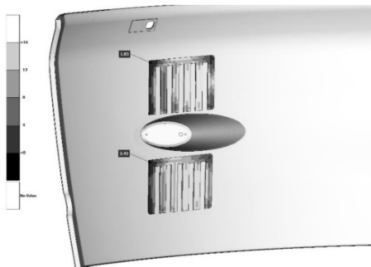
Obr. 5 Výsledky výpočtu lepených spojů
