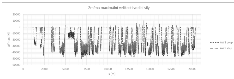
Obr. 7 Odchylka maximální hodnoty vodící síly AWS systémů od standardního vozidla
