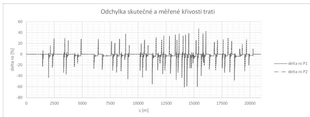
Obr. 5 Odchylka měřené a skutečné hodnoty křivosti trati vyjádřená v %
