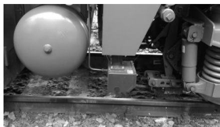
Obr. 4 Připojení sestavy dávkovače ke stávajícímu zásobníku písku na vozidle ř. 362 a ř. 754
