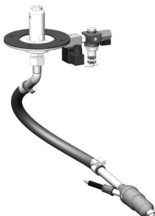
Obr. 6 Nová zmenšená sestava pískovacího zařízení
