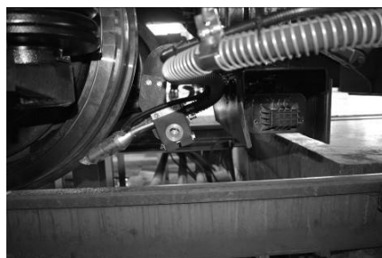
Obr. 5 Souprava vlaku HRCS2 a sestava pískovacího zařízení
