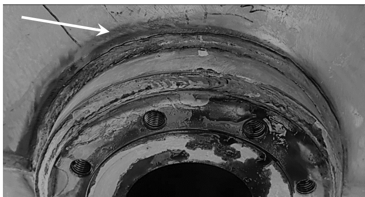
Obr. 3 Únavová trhlina v místě úchytů vybavení
