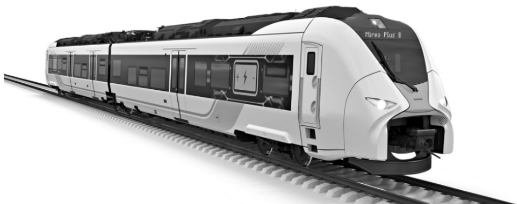
Obr. 10 Dvouzdrojové vozidlo trolej/akumulátor portfolia Siemens Mobility – Mireo Plus B [9]
