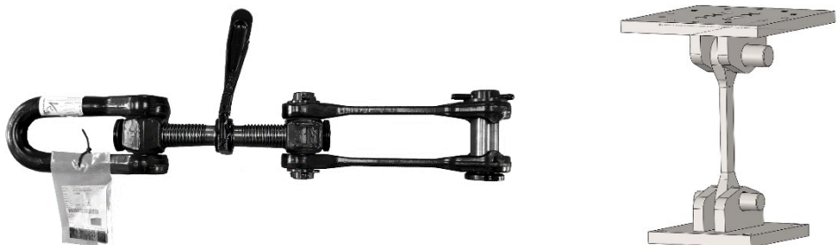
Obr. 8 Příprava tenzometrické měřicí šroubovky – šroubovka pro lokomotivu typu TRAXX určená k instrumentaci (vlevo) a návrh přípravků a sestavy pro kalibraci závěsnic na DZS (vpravo)
