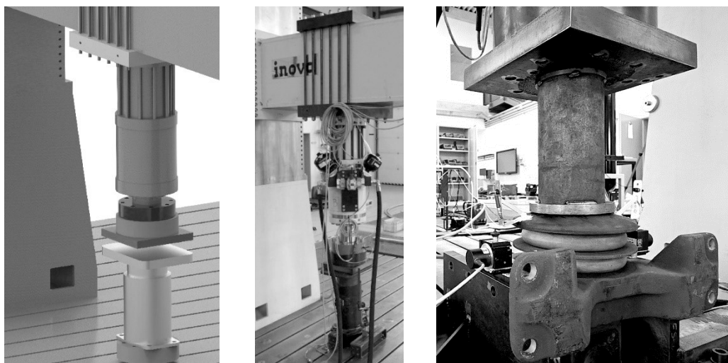
Obr. 5 Zjednodušený 3D model sestavy pro zkoušení nárazníku (vlevo), reálná sestava zkoušky nárazníku č. 1 na DZS (uprostřed) a sestava zkoušky vypružení spřahovacího ústrojí č. 2 na DZS (vpravo)
