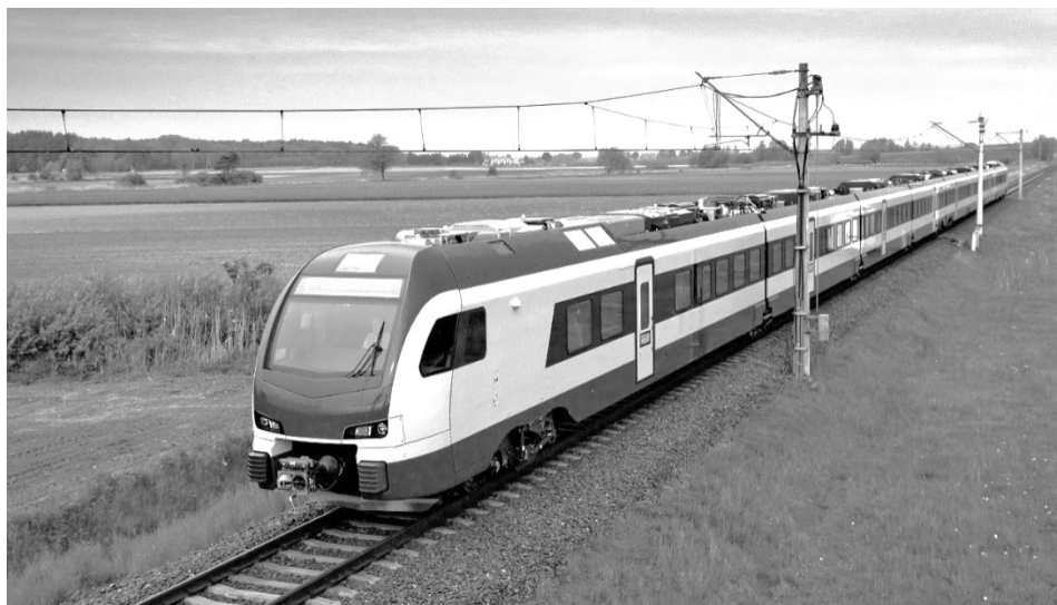
Obr. 2 Osmivozová jednotka FLIRT EMU PKP IC
