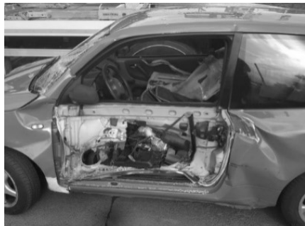
Obr. 4 Místo průniku spřáhla do prostoru pro cestující; zdroj: dopravacek.eu
