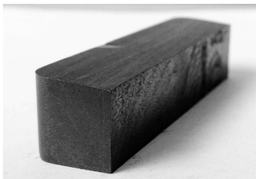
Obr. 2 Vzorek tuhého maziva pro dvoukotoučové zkušební zařízení
