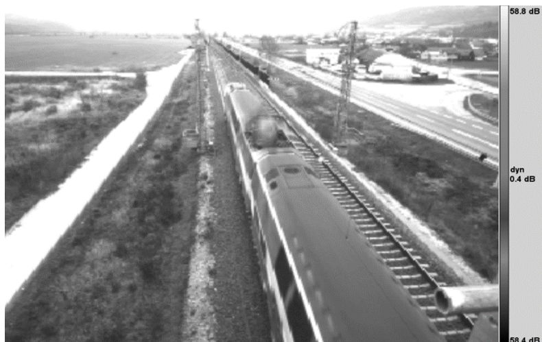
Obr. 7 Lokalizácia hluku od zberača elektrickej jednotky radu 671 pri 120 km/h
