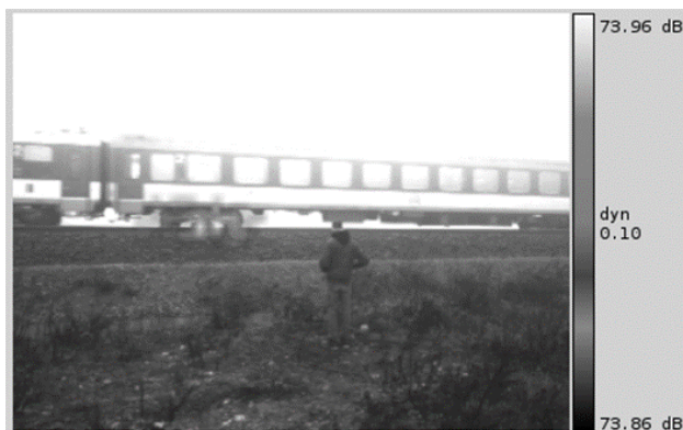
Obr. 4 Lokalizácia zdroju hluku od podvozku pomocou akustickej kamery
