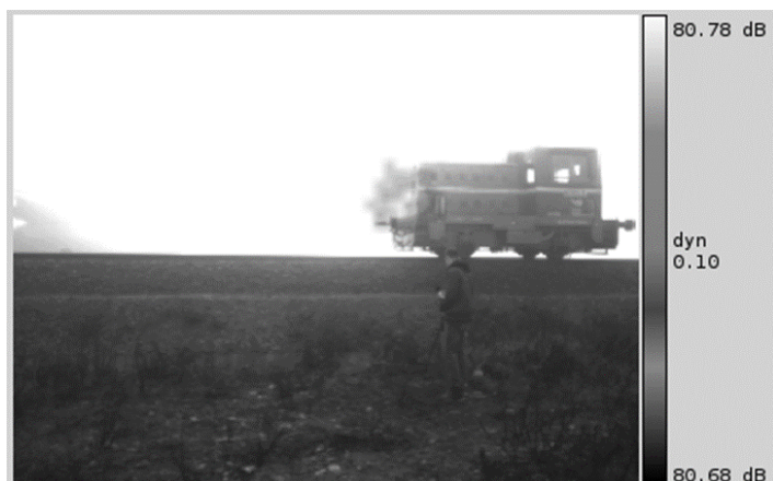
Obr. 6 Príklad použitia akustickej kamery pri identifikácii hluku pohonného ústrojenstva malého vozidla nezávislej trakcie
